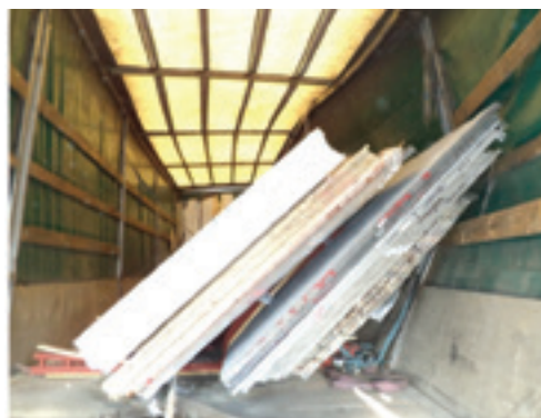
Figuur 45: Ingestort A-frame
