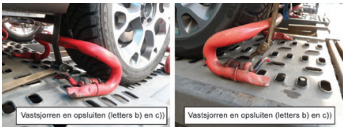
Figuur 58: Zekeringsmiddelen voor het vervoer van auto's
