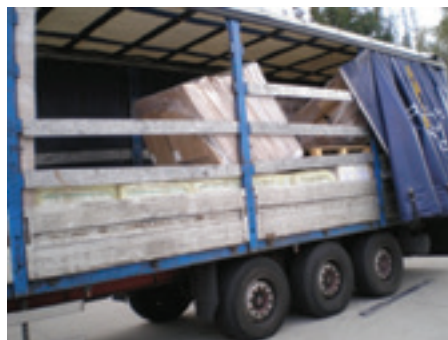
Figuur 19: onvoldoende zekering van de lading met behulp van uitsluitend rekwikkelfolie
