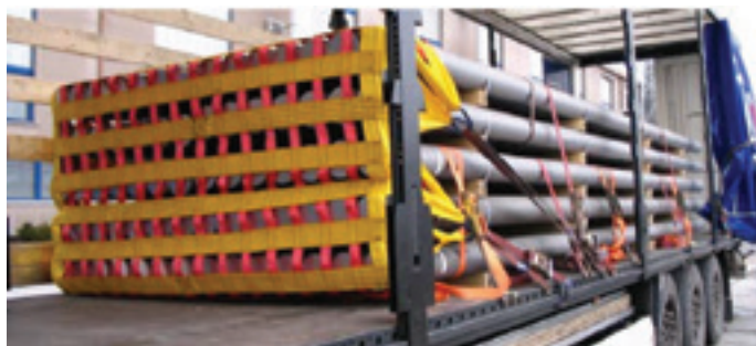
Figuur 32: Zekering met behulp van een net en directzekeren in voorwaartse richting
