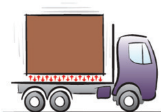
Figuur 3: Verticale trillingen tijdens het rijden
