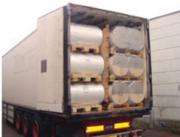
Figuur 28: Opvulmateriaal tussen de rijen van een lading
