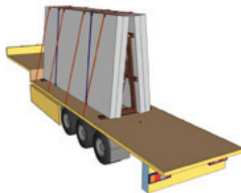
Figuur 48: Zekering d.m.v. een combinatie van opsluiten, A-frame, sjorring rondom en neersjorring
