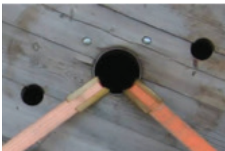
Figuur 22: Bescherming op scherpe hoeken
