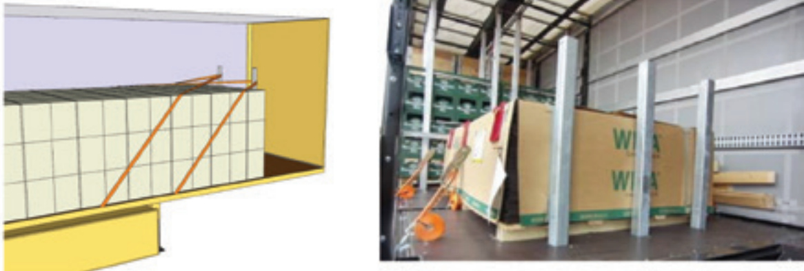
Figuur 7: Staanders die worden gebruikt voor opsluiten in voorwaartse richting
