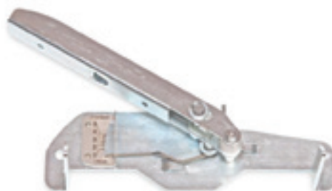
Figuur 23: Instrument voor het meten van de spankracht
