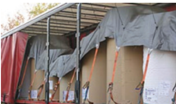
Figuur 31: Zekeren met afdekzeil
