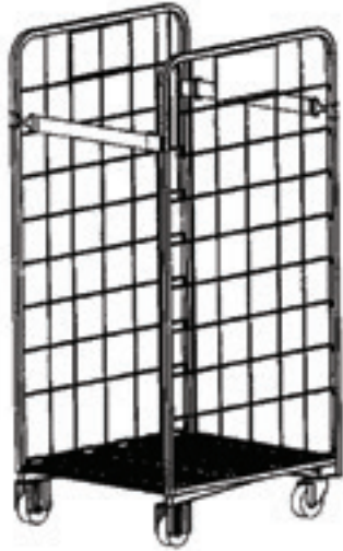
Figuur 70: Pallet voorzien van wielen, zijsteunen en klemriemen
