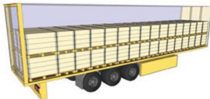
Figuur 12: Pallets stuwen in een voertuig met XL-code
