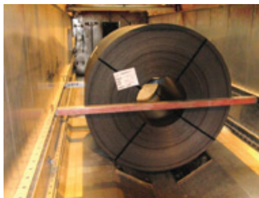
Figuur 61: Vervoer van een rol op een speciaal voertuig
