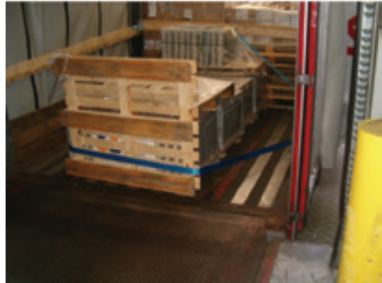
Figuur 75: Zekeringsmiddelen voor achterwaartse zekering van een gemengde lading
