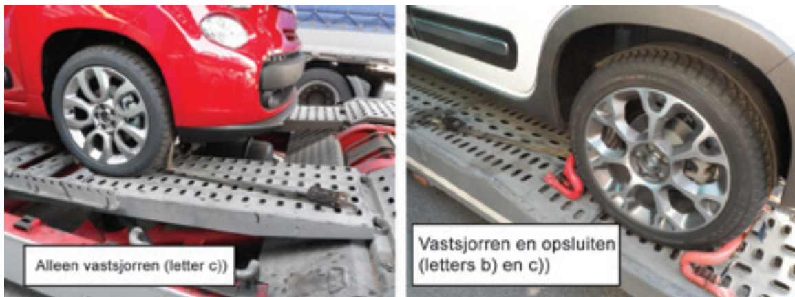
Figuur 57: Zekeringsmiddelen voor het vervoer van auto's
