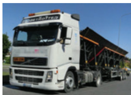
Figuur 14: Stalen platen vervoerd onder een hoek van 45°
