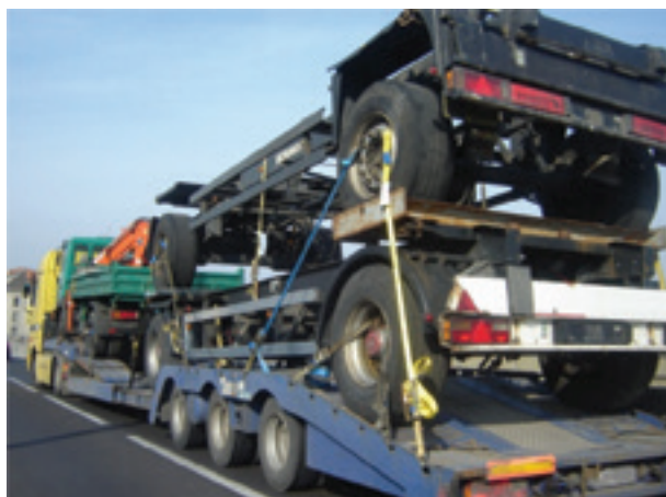
Figuur 59: Vervoer van vrachtwagens en aanhangwagens
