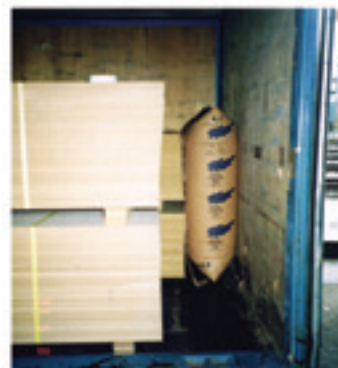
Figuur 29: Luchtkussens voor zijdelings opsluiten
