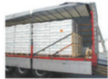
Figuur 39: Kopsjorren met behulp van pallets
