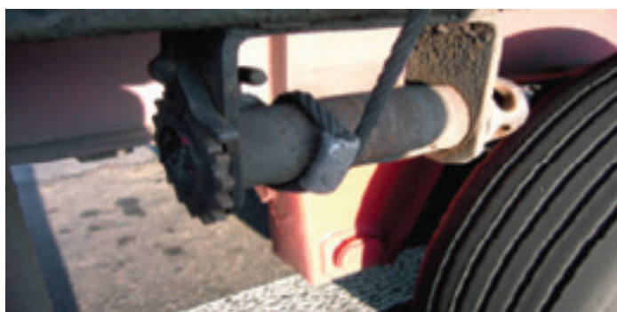
Figuur 24: Staalkabel onder spanning gezet door een lier
