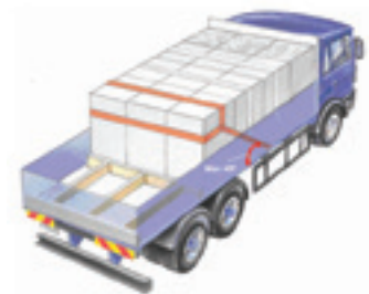
Figuur 40: Kopsjorren met behulp van een band
